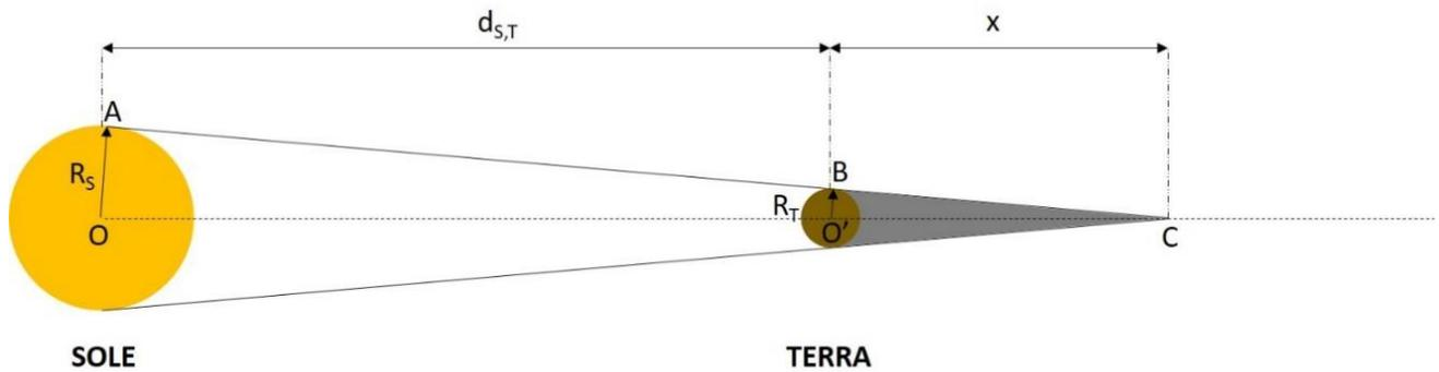
Nella figura i triangoli **CBO'** e **CAO** sono entrambi rettangoli, con l'angolo retto rispettivamente nei vertici **B** e **A** in cui il raggio terrestre  $R_T$  e il raggio solare  $R_S$  sono perpendicolari al segmento **CA**, che, per costruzione, è tangente sia alla Terra sia al Sole. Questi due triangoli, avendo in comune l'angolo in C, sono simili. Vale dunque la seguente proporzione:
